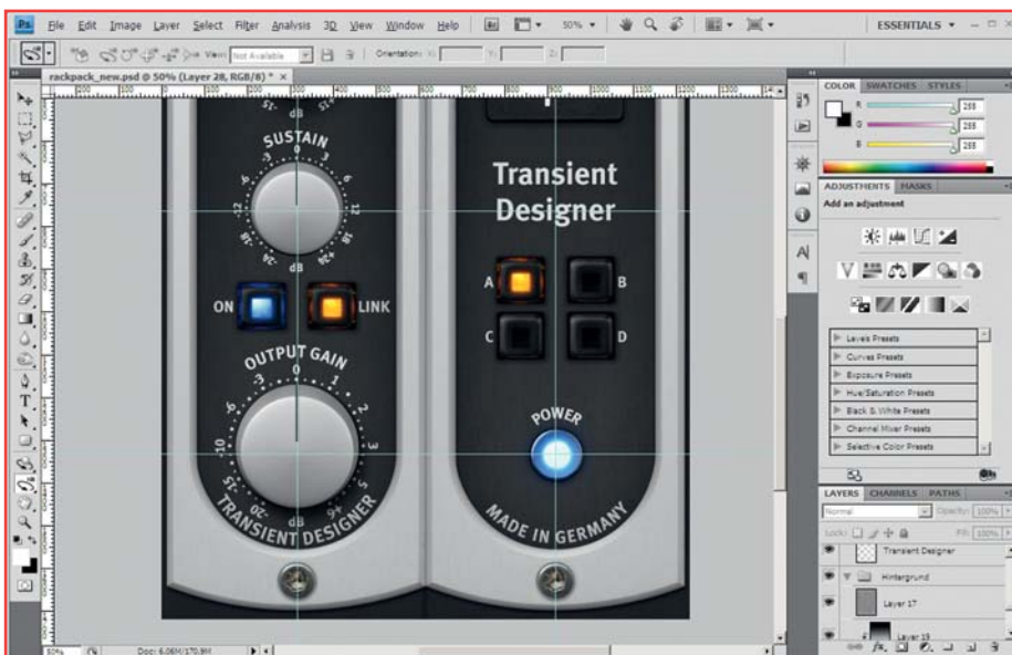
Beim Hardware-Modeling wird für das GUI das Original-Gerät fotografiert und die Fotos anschließend in Adobe Photoshop aufbereitet.
